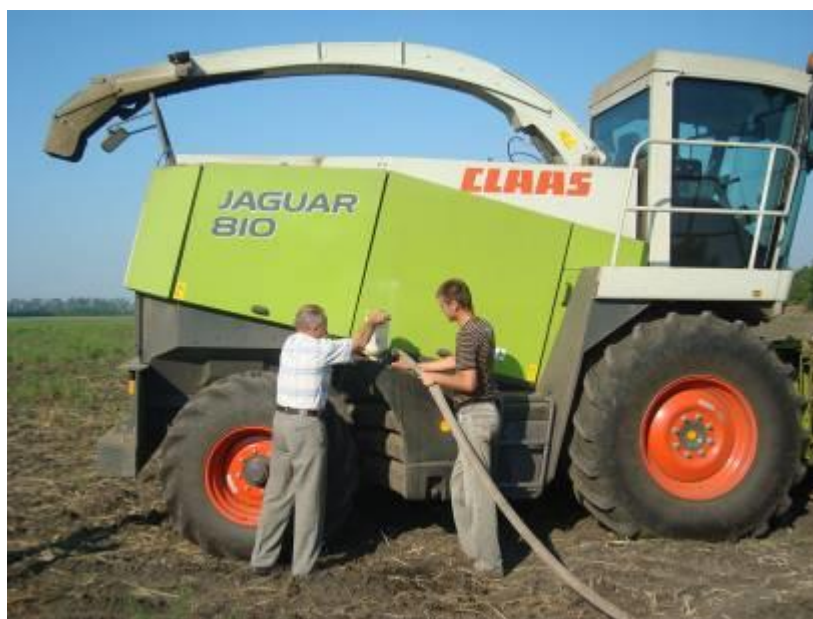
Рис. 2 Разбавление консерванта водой в баке на комбайне
