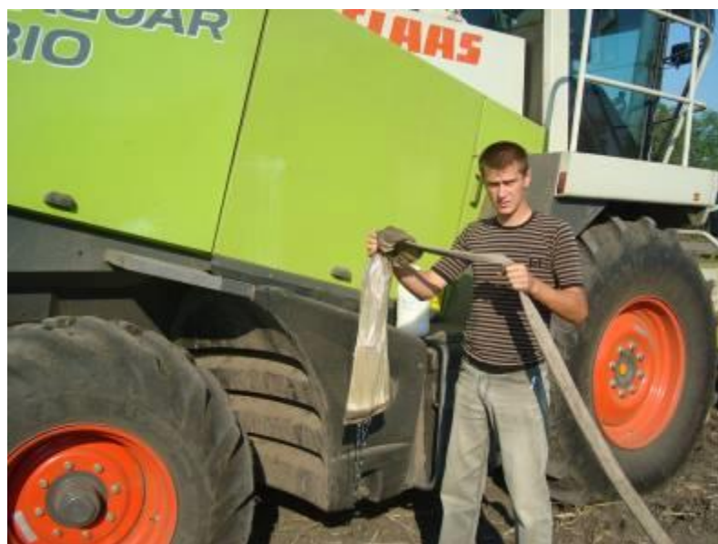
Рис. 1 Фильтр из капроновой ткани
