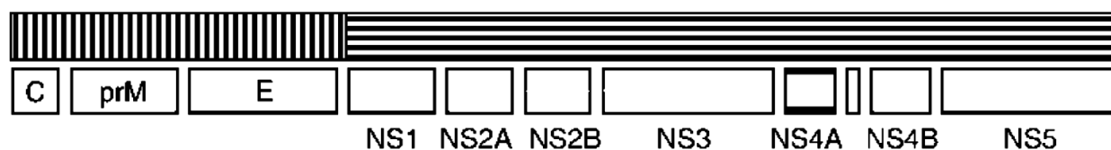
Рисунок 1 – Схема полибелка флавивирусов. Вертикальными линиями обозначена область структурных белков, горизонтальными – не структурных. Названия белков обозначены внутри прямоугольников и под ними
